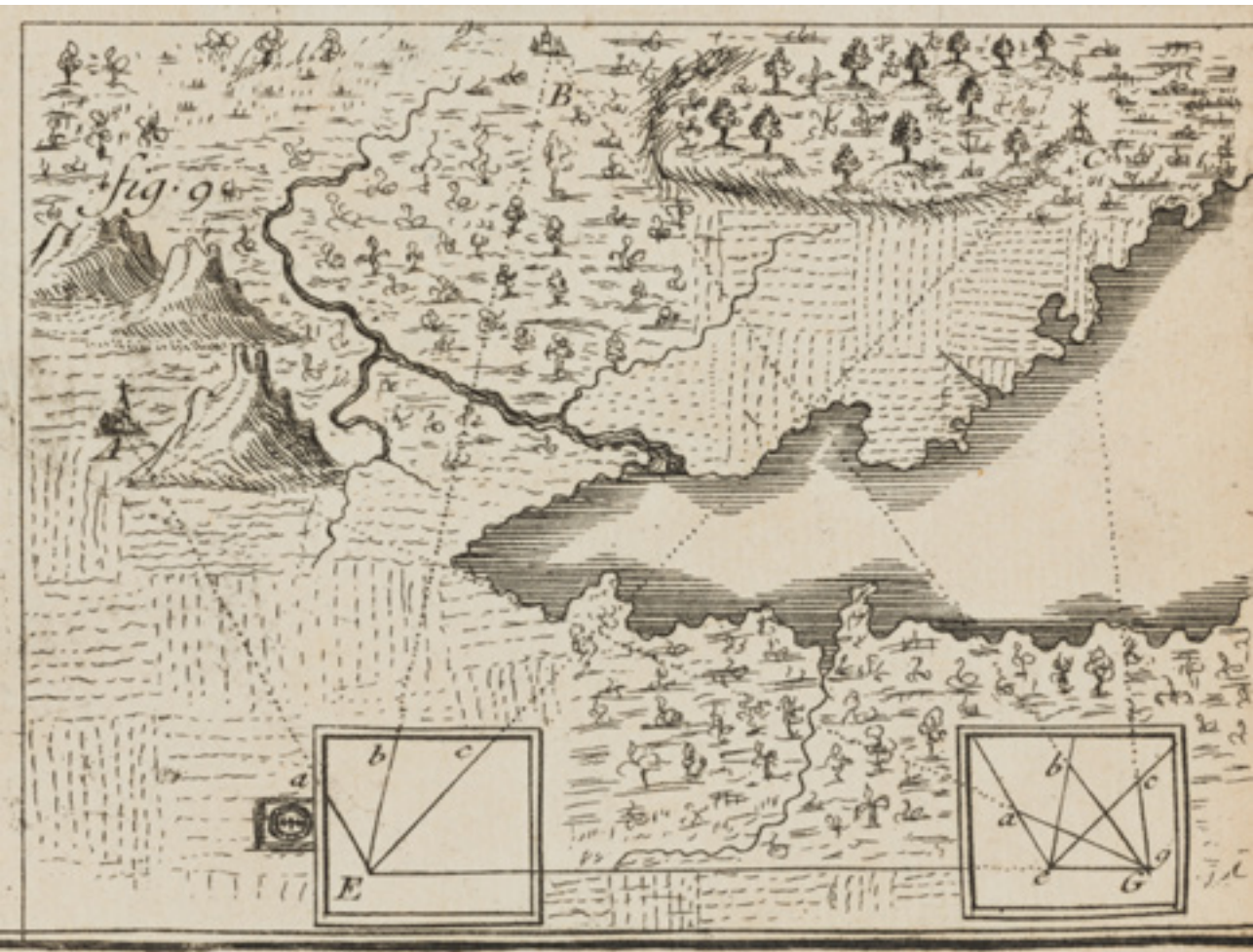
Illustratie 4: Constructie van het planchet, ook "Universeel instrument" genoemd en het gebruik van een eenvoudig planchet (BION N., Traité de la construction et des principaux usages des instruments de mathématiques , Parijs, 1715).
